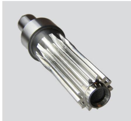
Präziseste Profile – im Bild ein Profilstempel – der im Teilapparat auf genaueste Toleranz geschliffen wird.
